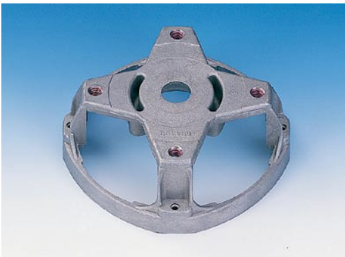
铝制花园锄草机发动机支架 使用自锁型 HELICOIL® plus SCREWLOCK® M8x12 防止螺丝松动
